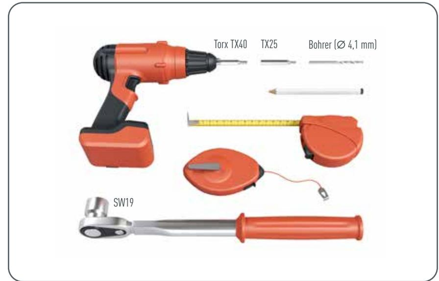
Abbildung 3 • Schneerechensystem XL – benötigtes Material
